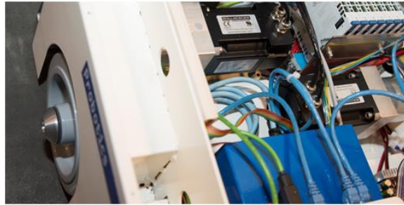
Optec her iki çark için tahrik olarak KOLLMORGEN'in AKM serisinden 48 voltluk seçeneğiyle senkron servo motorları kullanıyor
