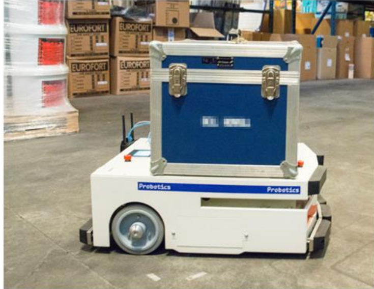
40 kilogram ağırlığındaki AIV'ler 150 kilogra kadar yükleri taşıyabiliyor.
